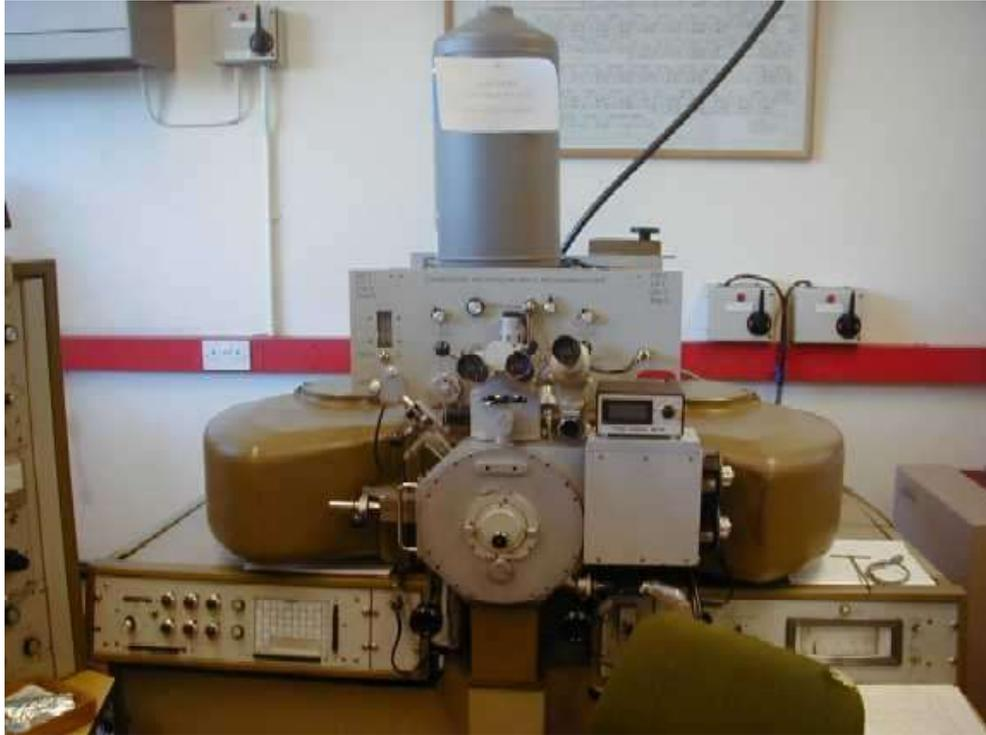
لوحة (4-2) : جهاز التحليل الالكتروني المجهرى الدقيق (MICROSCAN MK5) .
